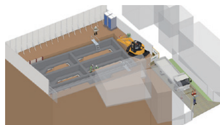
施工BIMの成果(掘削時モデル)
