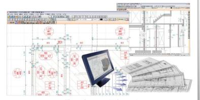
記号・寸法描画はもちろん、包絡・開口処理から 基礎伏図や断面図などの関連図面まで自動作成!
