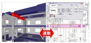
入力段階で常にパースモニタで3次元データの確認ができ、またパース上での修正が図面に連動するので整合性がUPします。
