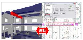
入力段階で常にパースモニタで3次元データの確認ができ、またパース上での修正が図面に連動するので整合性がUPします。
