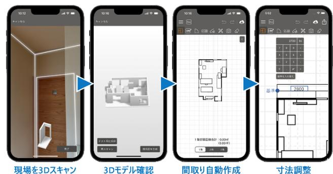
現場を3Dスキャン 3Dモデル確認 間取り自動作成 寸法調整
